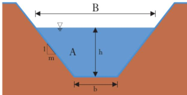
$A = A(x, t)$  es la área mojada del canal correspondiente a la posición  $x$  en el canal da brecha (rompimiento, ruptura) en el tiempo  $t$ .
